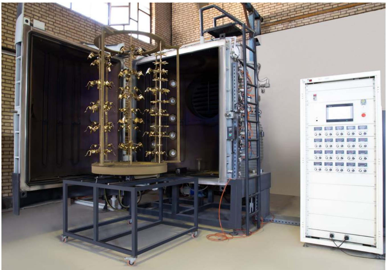
واحد PVD آبکاری تحت خلاء PVD (Physical Vapor Deposition)
